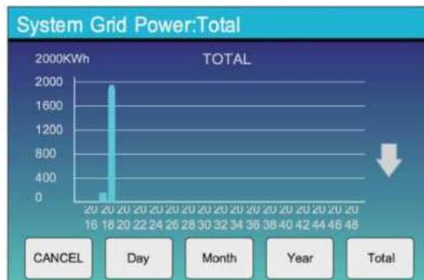
La curva di potenza solare giornaliera, mensile, annuale e totale può essere approssimativamente controllata sull'LCD, per una generazione di potenza più precisa, si prega di verificare sul sistema di monitoraggio. Clicca la freccia su e giù per controllare la curva di potenza di diversi periodi.
