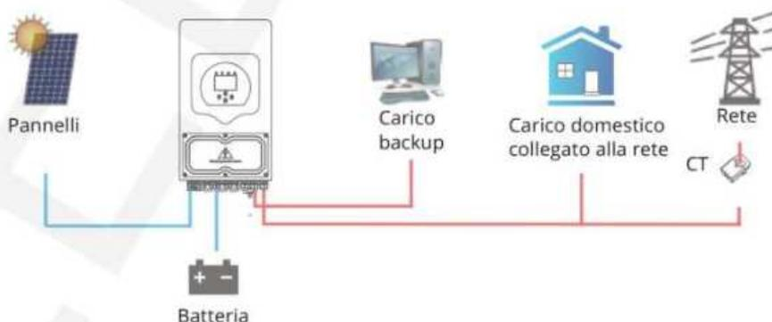
**Solar Sell:** "Solar Sell" è utilizzato per la modalità di "Zero export" verso il carico o "Zero export" verso il CT (Sensore di corrente): quando questo elemento è attivo, l'energia in surplus può essere venduta alla rete. Quando è attivo, la priorità di utilizzo delle fonti di energia solare FV è la seguente: consumo del carico, carica della batteria e alimentazione nella rete.
