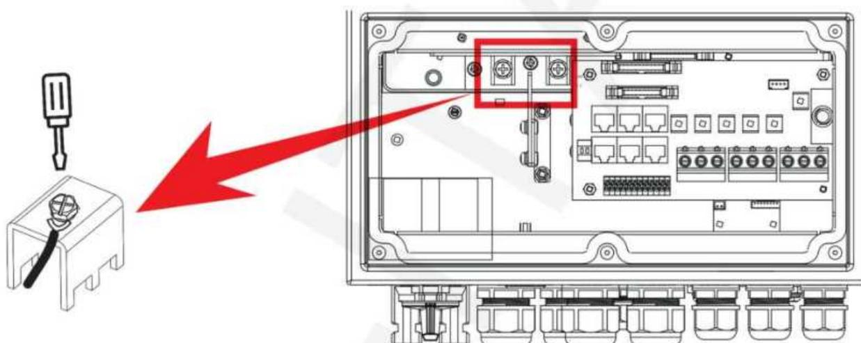
Per modelli di Inverter da 3.6kW/5kW/6kW, le dimensioni delle viti per i connettori della batteria sono M6.
