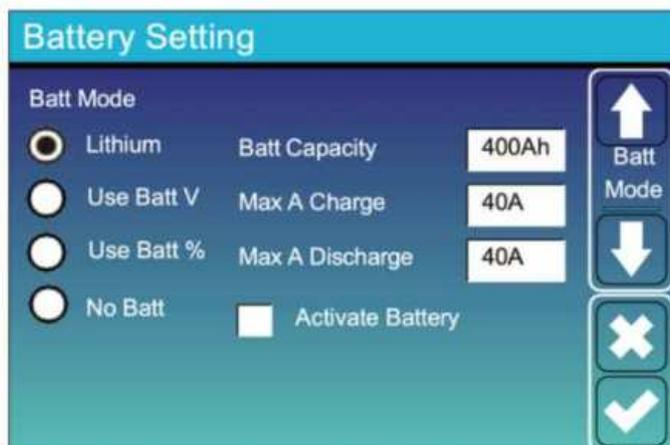
**Battery Capacity:** Indica all'inverter ibrido Deye le dimensioni della batteria.
