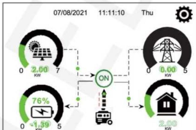
Questa pagina mostra la potenza del pannello solare e del generatore diesel, il carico e la batteria.
