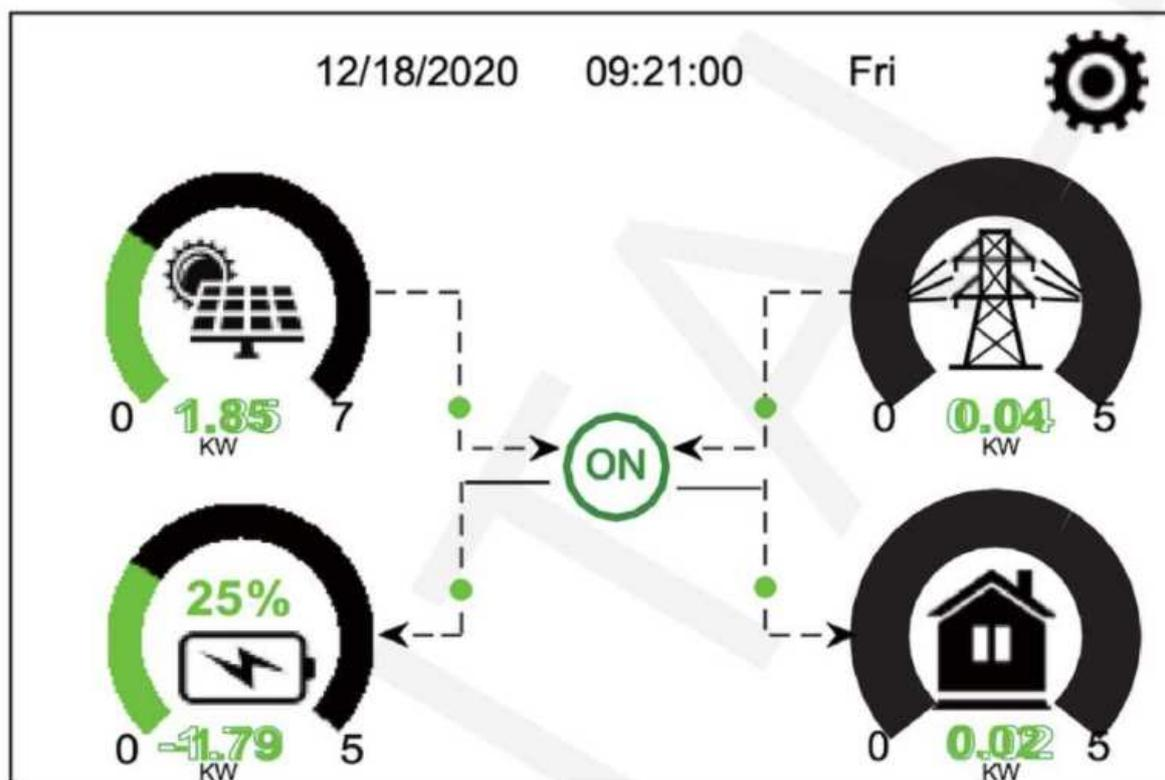
1. L'icona al centro della schermata principale indica che il sistema è in normale funzionamento. Se si trasforma in "comm./FXX", significa che l'inverter ha errori di comunicazione o altri errori, il messaggio di errore verrà visualizzato sotto questa icona (errori FXX, le informazioni dettagliate sull'errore possono essere visualizzate nel menù degli allarmi di sistema).
