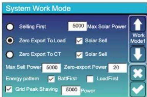
**Work Mode Selling First:** Questa modalità consente all'inverter ibrido di rivendere qualsiasi eccesso di energia prodotta dai pannelli solari alla rete. Se il "Time of Use" è attivo, anche l'energia della batteria può essere venduta alla rete. L'energia dei FV verrà utilizzata per alimentare il carico e caricare la batteria e quindi l'energia in eccesso verrà inviata alla rete. La priorità delle fonti di alimentazione per il carico è la seguente:
