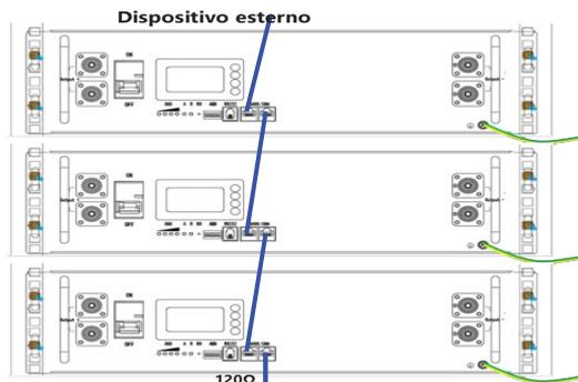
Figura 6-6 Collegamento della resistenza da 120Ω
